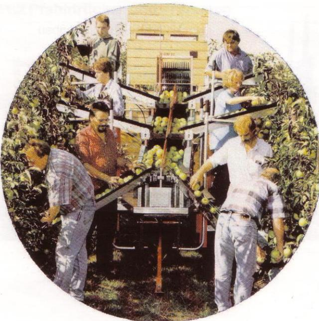
Selbstfahrende Maschine für die mechanisierte Ernte von Tafelobst
